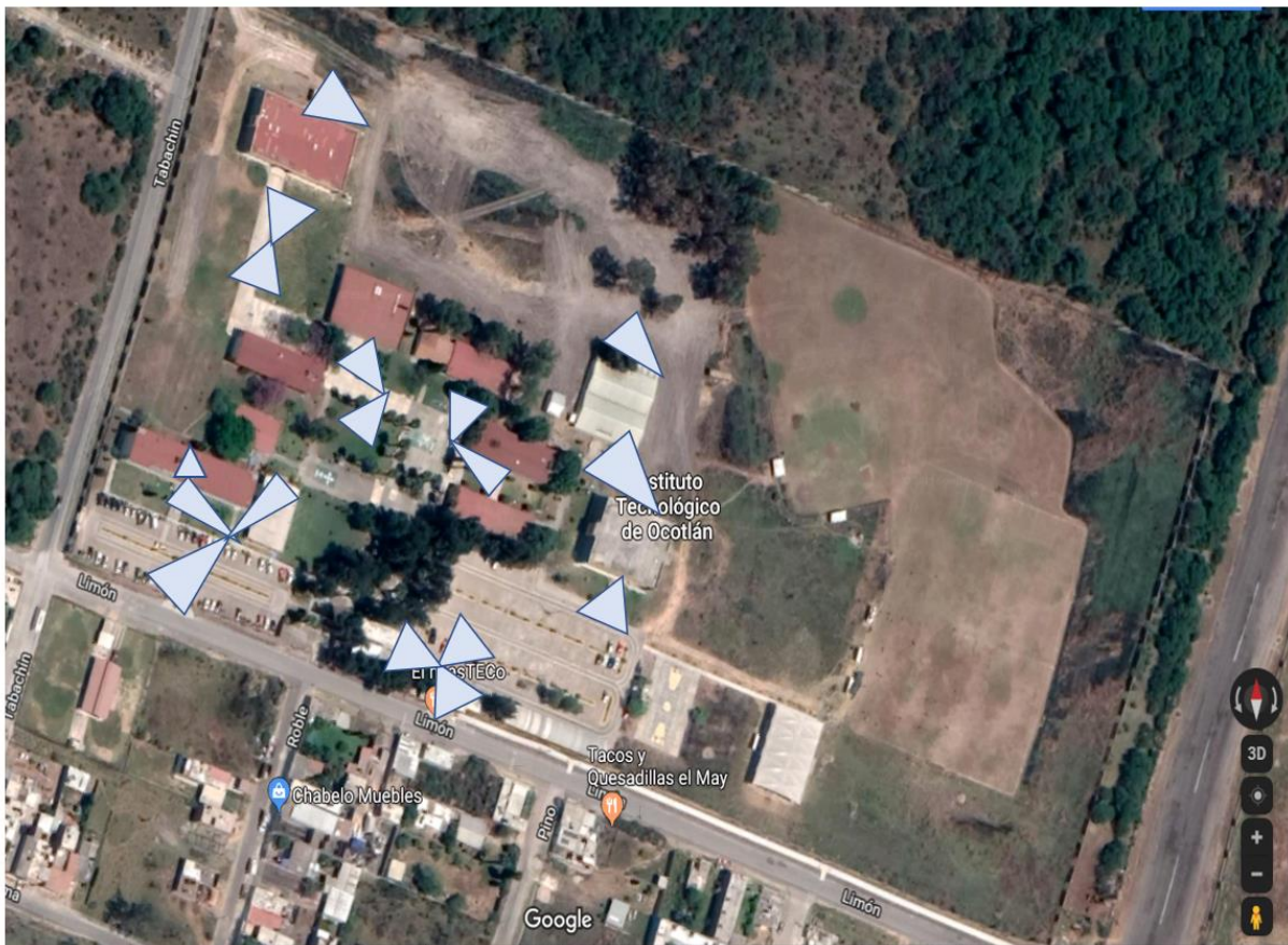
Imagen 2, Localización de las cámaras de video-vigilancia
